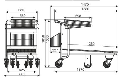
Стандартно тележка имеет обычные колёса. Добавочные аксессуары (м.д. колёса со стопором, монетоприемник, логотип и другое оборудование) согласовываются дополнительно.
