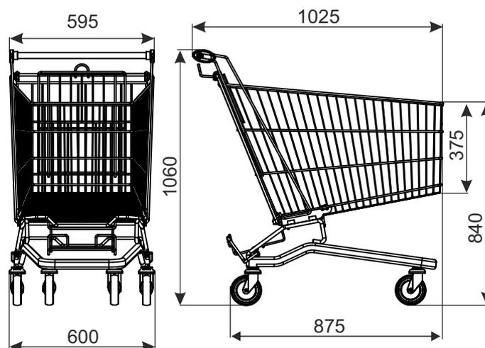
Стандартно тележка имеет обычные колёса. Добавочные аксессуары (м.д. колёса со стопором, монетоприемник, логотип и другое оборудование) согласовываются дополнительно.
