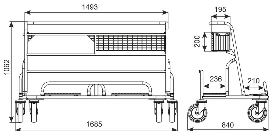
Der Wagen dient zum Transport von Gipskartonplatten, Möbelplatten, Sperrhölzern, Türen etc. mit der maximalen Höhe bis 1250 mm. Zusätzlich ist der Transportwagen mit einem Drahtkorb für Transport der kleinen Waren ausgestattet.
