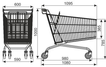
Стандартно тележка имеет обычные колёса. Добавочные аксессуары (м.д. колёса под траволаторы либо со стопором, монетоприемник, логотип и другое оборудование) согласовываются дополнительно. Внимание: в случае применения колёс под травелаторы, грузоподъёмность тележки состоит 130 кг.
