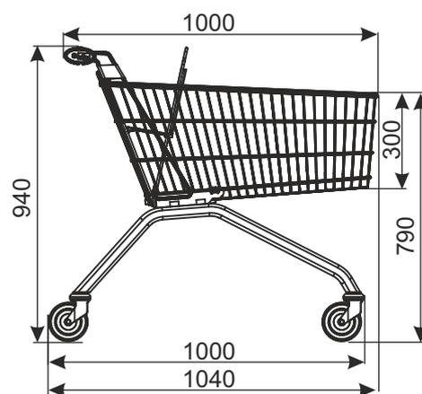
Стандартно тележка имеет обычные колёса. Добавочные аксессуары (м.д. колёса под траволаторы либо со стопором, монетоприемник, логотип и другое оборудование) согласовываются дополнительно. Внимание: в случае применения колёс под травелаторы, грузоподъёмность тележки состоит 130 кг.
