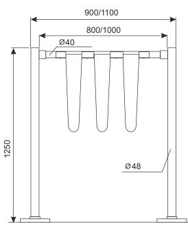
Переезд для тележек являет собой соединитель из трубы  $\varnothing 40 L 800-2000$  мм и пластмасовых элементов светло серого цвета прикремленных к соединителю.
