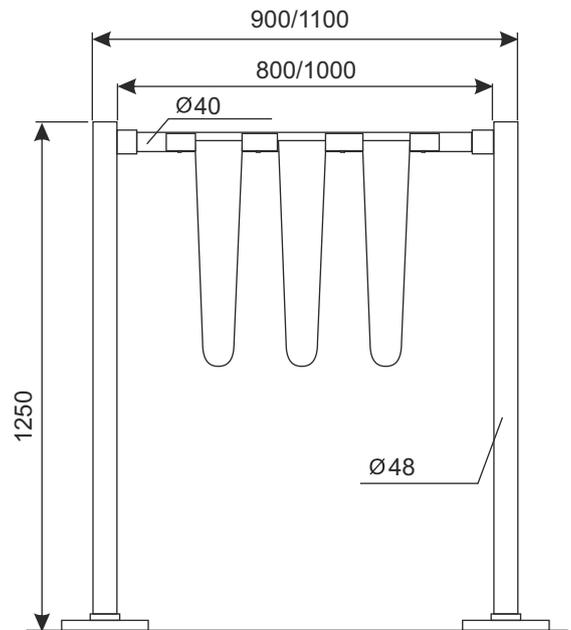
Wagendurchschub ist aus Querstange aus Rohr  $\varnothing$  40 L 800-2000 mm gemacht mit kunststoff lichtgrauen Sperrbügeln, die auf Stange gehängt werden.
