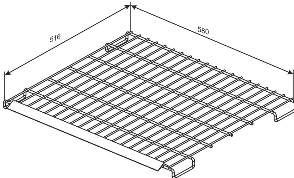
Das am Tischgestell montierte Fachboden bietet zusätzliche Fläche zur Ausstellung oder Lagerung der Ware. Der untere Fachboden ist an dem Untergestell von Drahttisch montiert. An einer Seite ist die Preisschiene fixiert.
