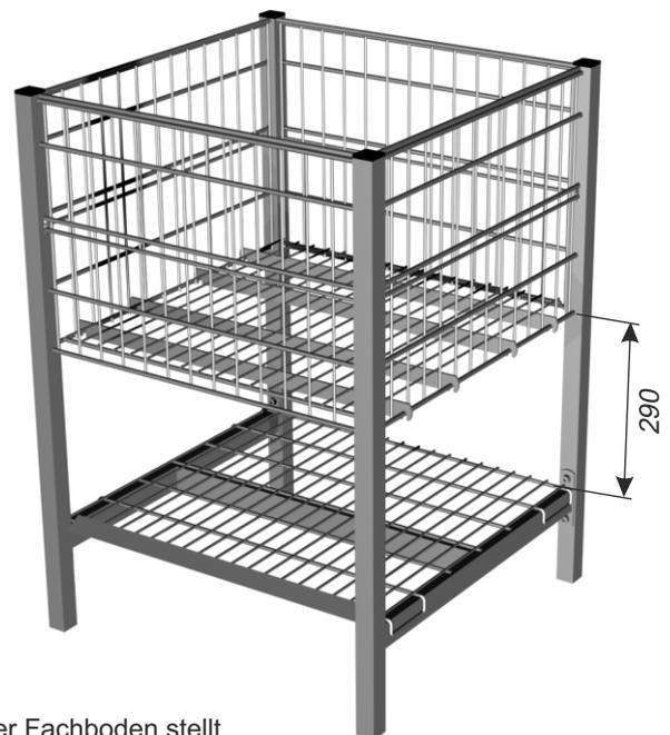
Unterer Fachboden stellt zusätzliche Ausrüstung und eignet sich für die Montage auf dem Drahttisch 600x600.
