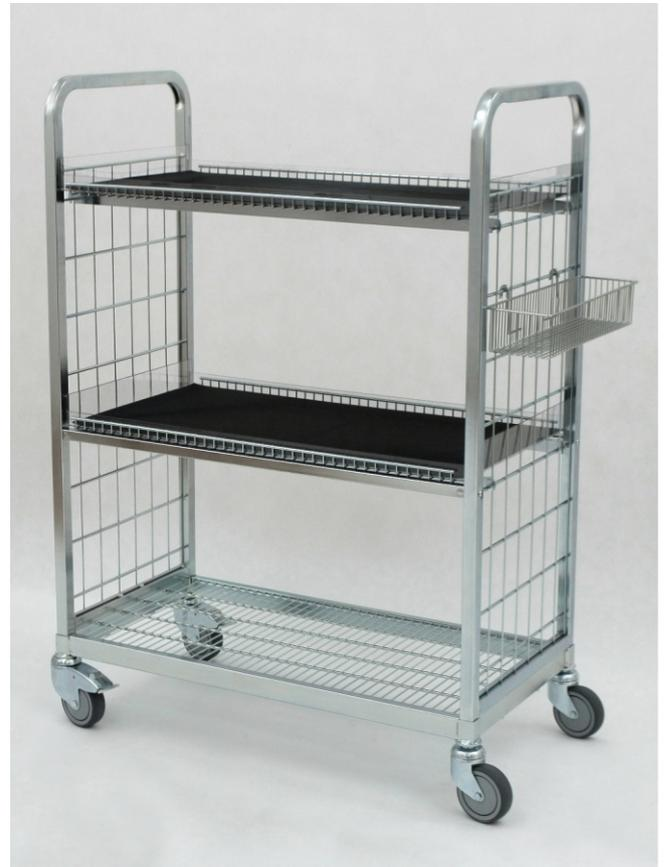
Контейнер для экспозиции товаров. Конструкция контейнера сборная и скрученная. Несущая конструкция произведена из профиля, полки из проволоки. Возможное регулирование высоты завешивания полок в контейнере. Шаг перестановки полки 110 мм. Полки и базис выстланные плексигласом для предохранения от выпадения мелких продуктов. Колёса поворотные, в т.ч. 2 шт. со стопором. Дополнительная опция: корзина для сканера кодов.
