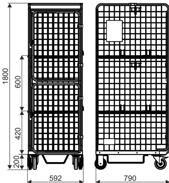
**Покрытие:** цинк гальванический + лак
