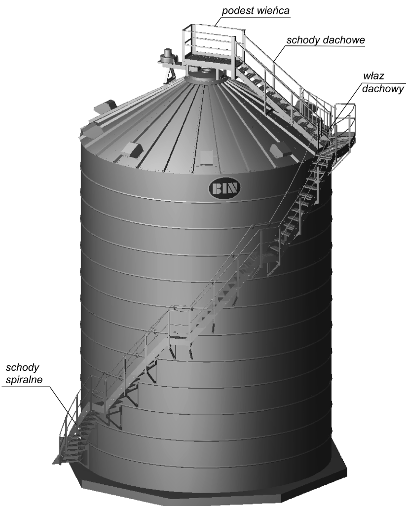
Kompletacja schodów spiralnych
